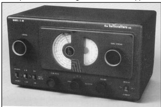
Hallicrafters S-38, en av de första heltäckande mottagarna som presenterades 1946.
